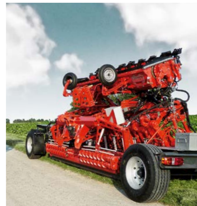
Dvakrát resp. čtyřikrát zušlechtněné vyorávací válce se zvýšenými závity.
