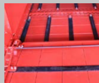
Zentrálně uložená příčná škrabáková podlaha pro co nejrychlejší vyložení zásobníku
