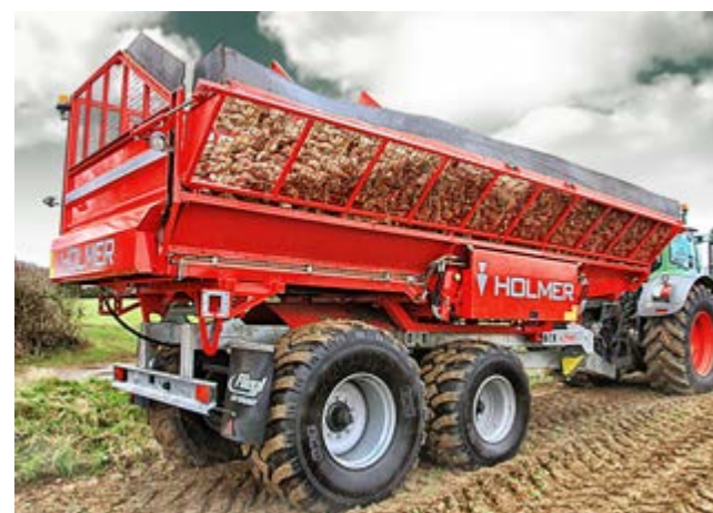
HOLMER TransCart se zásobníkem na řepu
