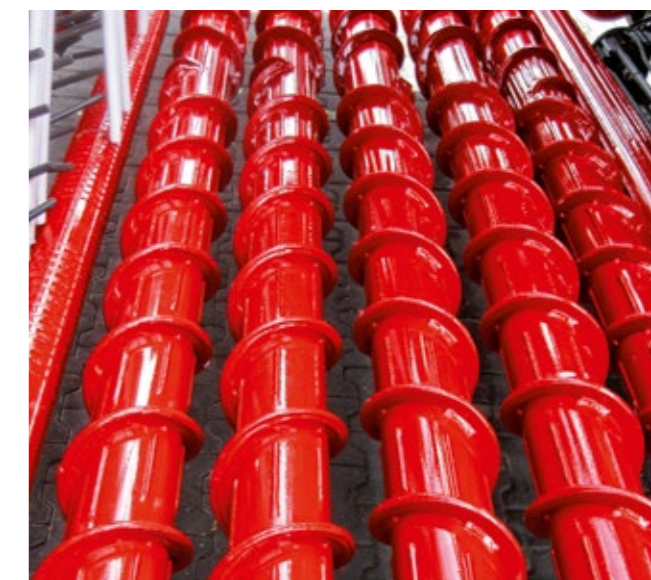
Dvackrát resp. čtyřikrát zušlechtné vyorávací válce se zvýšenými závitů
