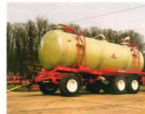
Beide Zubringer werden wahlweise in 25- oder 40- km/h- Ausführung geliefert. Die üblicherweise durch Fremdpumpe befüllten Fahrzeuge können auch mit Kompressor oder mit Pumpe ausgestattet werden.
